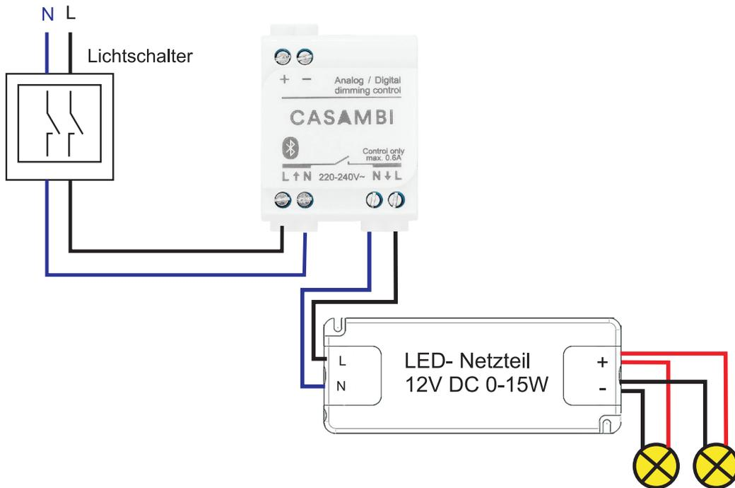
Dieses Gerät darf nur von einem qualifizierten Elektro-Fachmann installiert werden!
